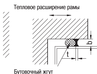
Рис. 4 Разрез по плоскости уплотнения (нагрузка на срез)
